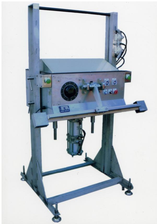
※写真の高さ調整はエアシリンダー方式になっています。違う製品がランダムに流れる場合瞬時に所定の高さに切替出来ます。
