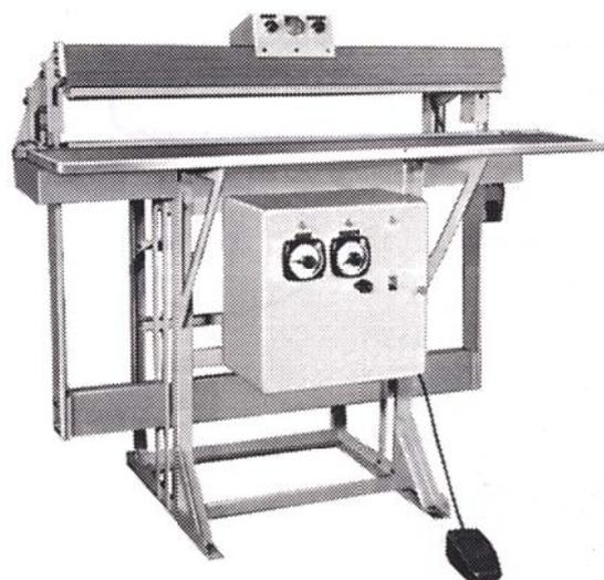
長尺物の接着、自動包装機及びラミネート機等の原反の自動繋ぎ装置としてあらゆる分野で採用されています。各機種とも動力源にエアシリンダーを採用していますので保守及び操作が簡単でどんな条件のフィルムでも面圧が強く均一にかかりますので最高の接着条件が約束されます。
